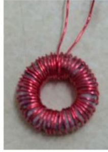
圖一 以漆包線纏繞環狀 LSMO 塊材製作出來的電感元件。
