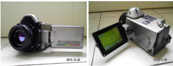
圖 4 NEC Avio TVS-200EX 紅外線遙測溫度熱像分析儀 （左：儀器正面；右：儀器背面）
