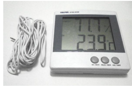
圖 5 TECPEL DTM-303B 室內外數位溫溼度計
