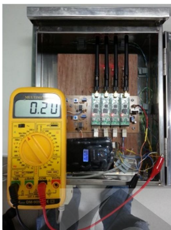
圖二：整合完成的模組總電流
