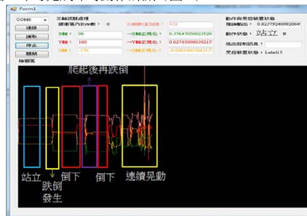
圖 9、站立→跌倒發生→倒下→爬起→倒下連續動作之程式即時判斷
