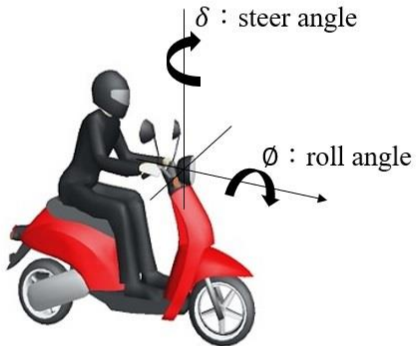
圖 5.2.1 摩托車側傾時影響頭燈變化角度
