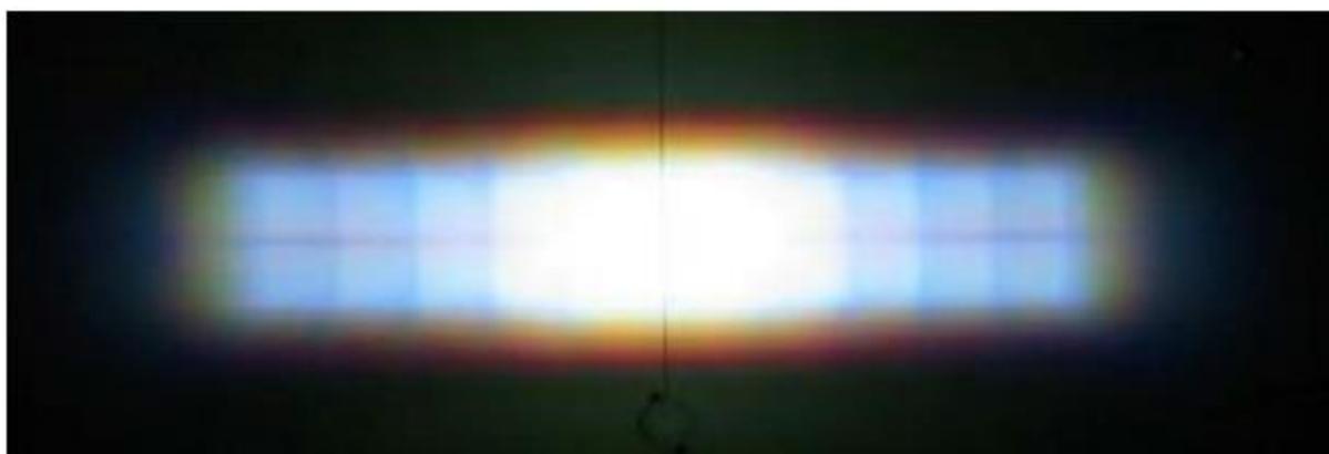
圖 2.3.7 適路性先進 LED 陣列頭燈實際光型[28]
