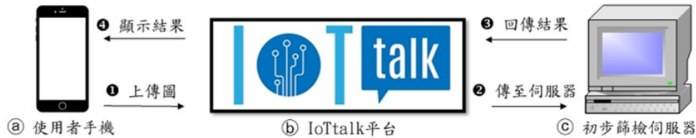
圖 4.1 初步篩檢系統架構示意圖
