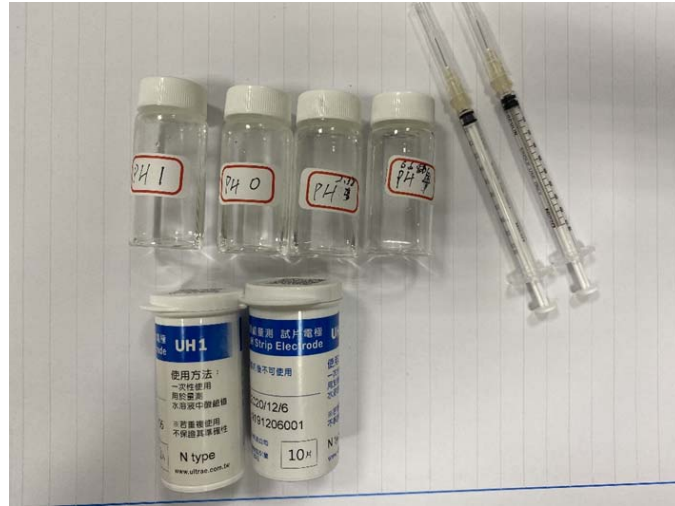
圖 17 測試實驗酸鹼溶液標準液與試片
