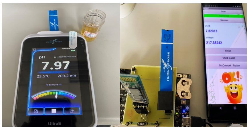
圖 20 商用儀器與本平台檢測結果(M 試驗者)
