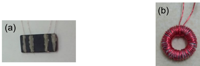
圖 1:(a)長條狀 LSMO 塊材。四個銀膠電極連接純銅導線。(b)以漆包線纏繞的環狀塊材。
