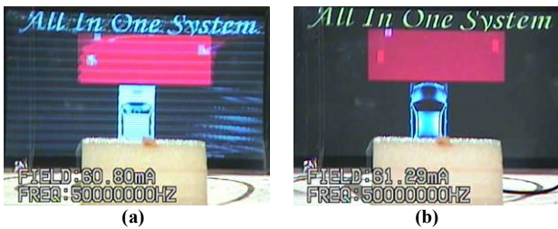
圖六 BCI 試驗結果：(a)一般線材 (b)具屏蔽效果線材
