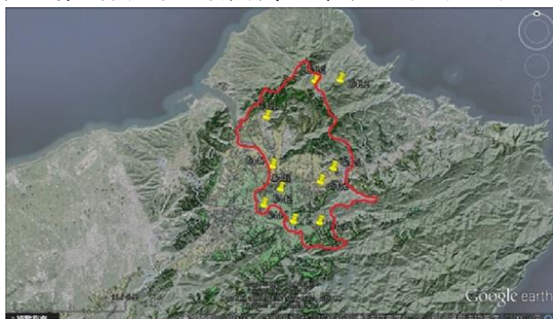
圖八 感知發射端 4 號當領導人時所能涵蓋的區域
